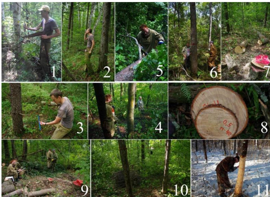
Рис. 1. Фотография работ на пробных площадях. 1 – определение диаметра дерева на высоте 1,3 м с нанесением отметки; 2 – измерение высоты дерева; 3 – взятие керн у комля растущего дерева; 4 – рубка модельного дерева; 5 – обрубка ветвей у модельного дерева; 6 – определение у растущего дерева радиусов кроны по сторонам света; 7 – деление ствола по относительным длинам; 8 – спилы, взятые на относительных высотах 0,2, 0,5 и 0,8 Н; 9 – определение диаметров и радиальных приростов на относительных высотах и работа по обрезке охвоенных побегов; 10 – подвесная система для взвешивания крон деревьев; 11 – подготовка углового столба на ППП.
